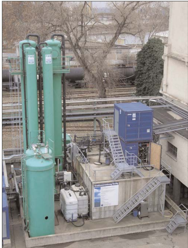
Der Schadstoffaustrag über das geförderte Grundwasser mit den Leitparametern Dichlormethan, Monochlorbenzol, Naphtalin, BTEX, LHKW's betrug 120.000 kg. Zudem wurde direkt an den Brunnen 48.000 kg organische Phase abgezogen.
