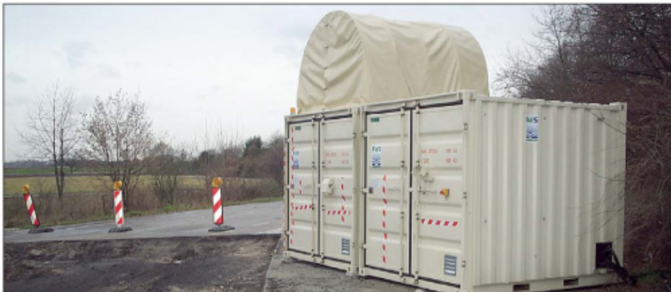
Die Anlage für einen Durchsatz von 5 m 3 /h mit Spezialaktivkohle zur Einhaltung der pH-Eingangskonzentrationen im Versickerungsbrunnen ersetzt teure Investitionen zur Einstellung des CaK - Kohlensäure - Gleichgewichtes.
