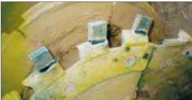
Speziell entwickelte Kressesegmente der Wendewalze
