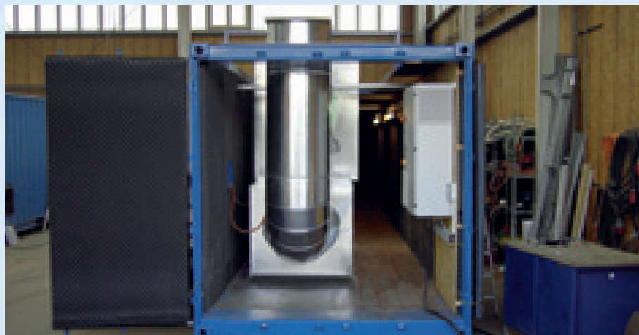
▲ Die für das Speditionsunternehmen Karl Schmidt GmbH & Co. KG konzipierte Anlage verfügt über einen indirekten Wärmeaustauscher mit hohem Wirkungsgrad. Dieser optimiert die Betriebskosten.
