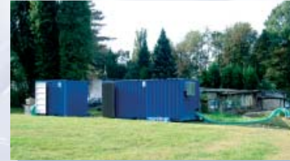
Die in Containern installierte Bodenluft-Absauganlage besteht aus einem Wasserabscheider und Aktivkohlefiltern.
